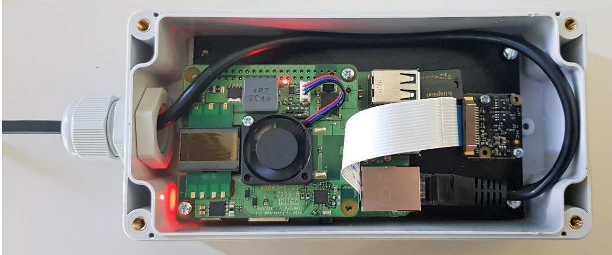
Abbildung 66 PoE Kamera im offenen Gehäuse
